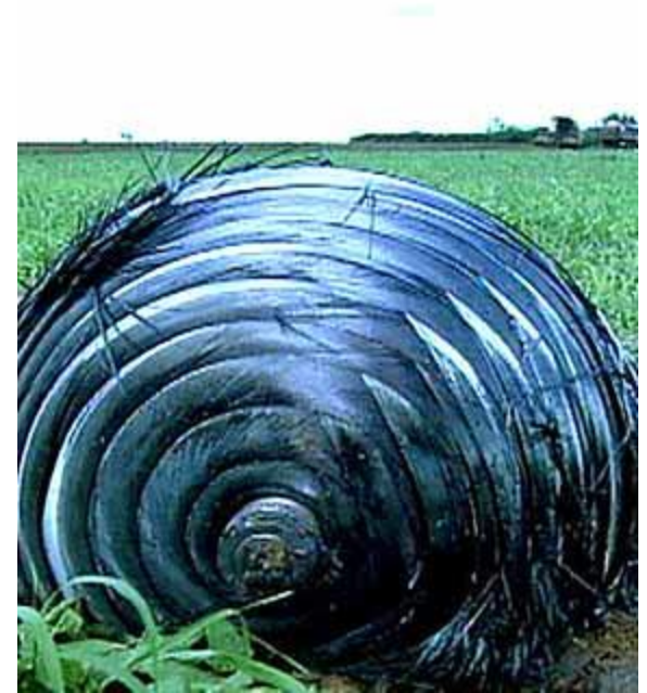
Fig. 9- Tanque de nitrogênio de alta pressão usado em sistemas de propulsão líquida, comum em satélites e foguetes encontrado em uma fazenda perto de Montividiu-GO é um (Danilo Cunha/O Popular/Agência Estado 03/2008).
