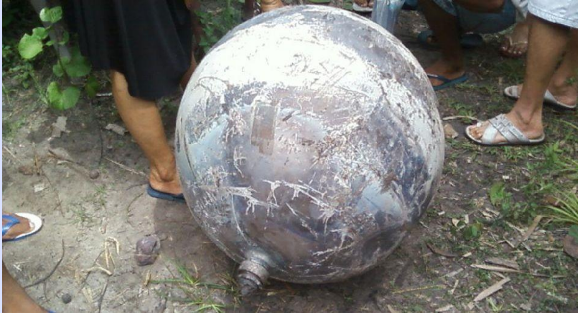
Fig. 8- Reservatório de Hélio do terceiro estágio de um foguete Ariane 4 com aproximadamente 30 quilos e 1 metro de diâmetro caiu na zona rural do município de Anapurus - MA, a 275 km de São Luis (Foto: Max Mauro Garreto 02/2012)
