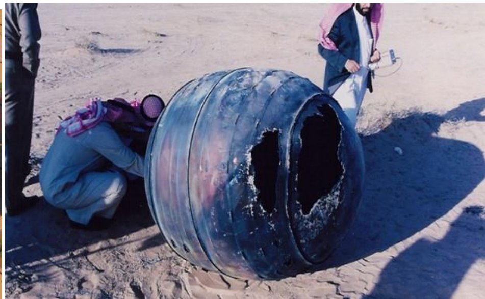
Fig. 11- Em janeiro de 2001, o motor de titânio do PAM-D, um módulo assistente de lançamento do foguete Delta 2, reentrou na atmosfera e caiu na Arábia Saudita (Foto: Divulgação/NASA Johnson Space Center).
